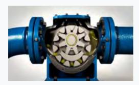
**A).** Double acting gear pump डबल एक्टिंग गियर पंप
